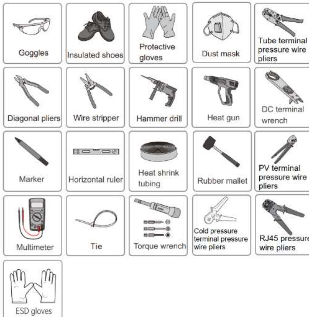
Figura 5-1 Strumenti consigliati per l'installazione
