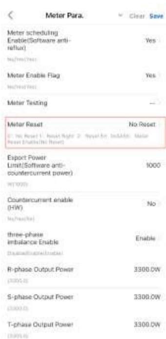
Figura 9-31 Ripristino del contatore 1
