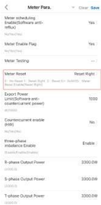
Figura 9-33 Ripristino del contatore 3
