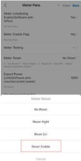
Figura 9-32 Ripristino del contatore 2
