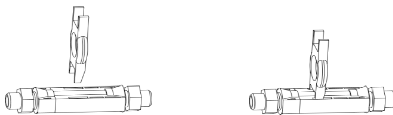
Figura 4-2 Schema della rimozione del terminale CC
